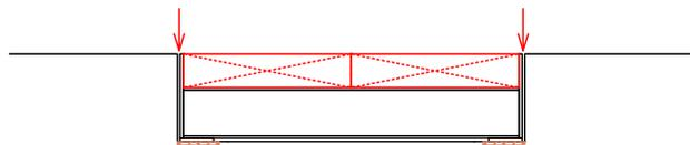
○LY設置。。。中間プレートを設置し、ボルトナットにて緊結する。
